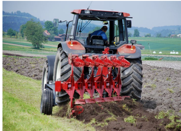
Alternativ zum herkömmlichen Pflug kann der Umbruch einer Klee graswiese mit dem Schäl pflug erfolgen.
