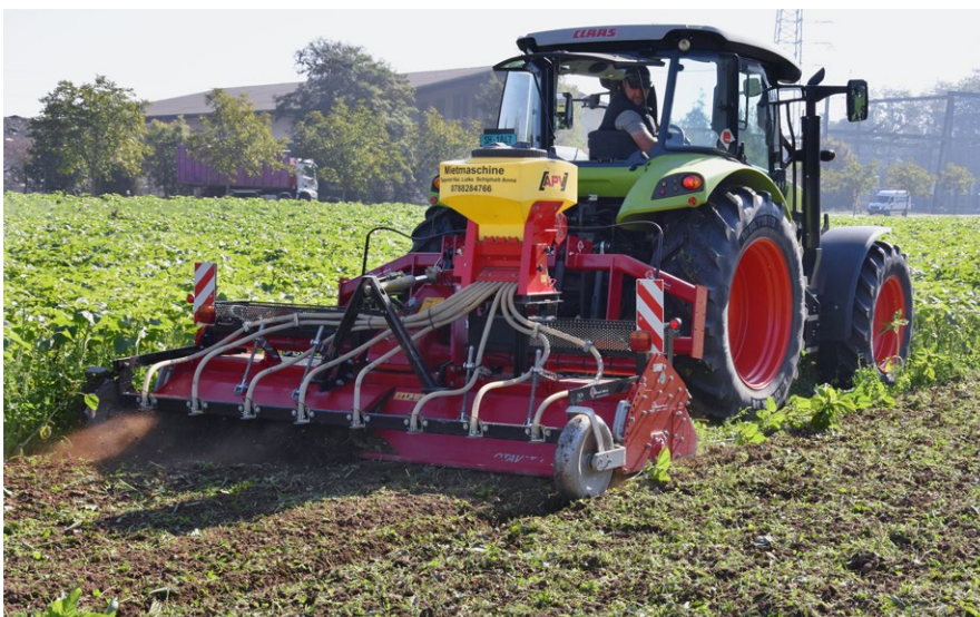
Bei Gründungen mit einer geringen Masse können die Einarbeitung und die Aussaat der Folgekultur in einem Arbeitsgang erfolgen.
