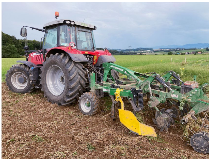
Der Kerner Corona Sternradgrubber mit Striegelwalze hat sich bestens bewährt.
