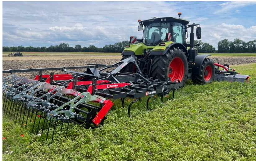
Saatkombinationen mit einer Messerwalze an der Front und einer Federzahnegge kombiniert mit einer Walze können Gründungen in einem Durchgang ohne Zapfwellenantrieb leicht einarbeiten.
