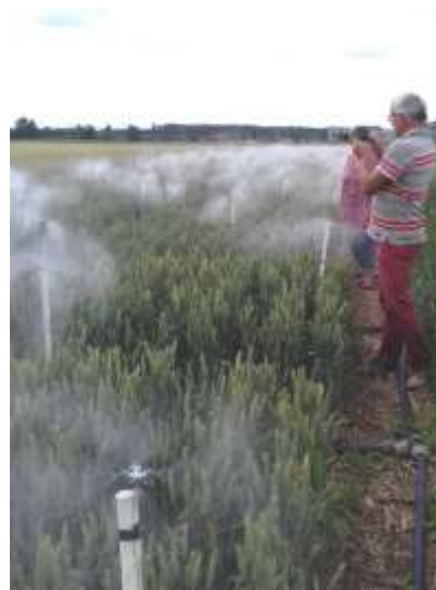
Die Vernebelungsanlage am Standort Colmar zur Untersuchung von Produkten des Biologischen Pflanzenschutzes zur Bekämpfung von Ährenfusarium bei Weizen
