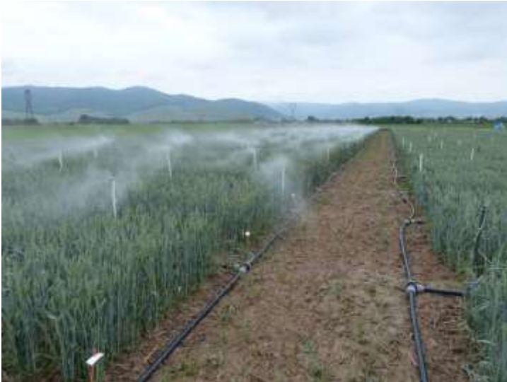
Die Vernebelungsanlage am Standort Colmar zur Untersuchung von Produkten des Biologischen Pflanzenschutzes zur Bekämpfung von Ährenfusarium bei Weizen
