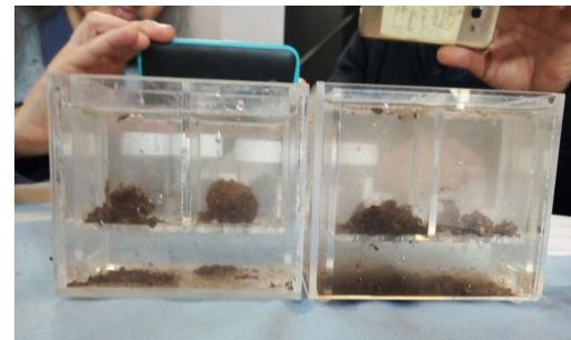
Slack test – diagnostic de la structure du sol
