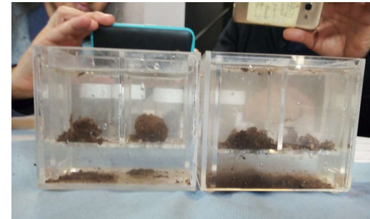
Slack test – diagnostic de la structure du sol Slake Test: Diagnose der Bodenstruktur
