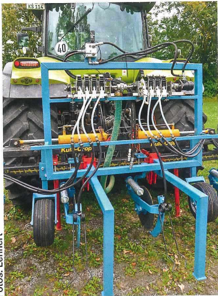
Der Prototyp einer Schlauchpumpe für die Dosierung der Nematodenlösung.
