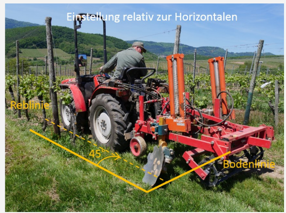
Der Neigungswinkel der Scheibe beträgt 45^\circ in Bezug auf die Reblinie.
