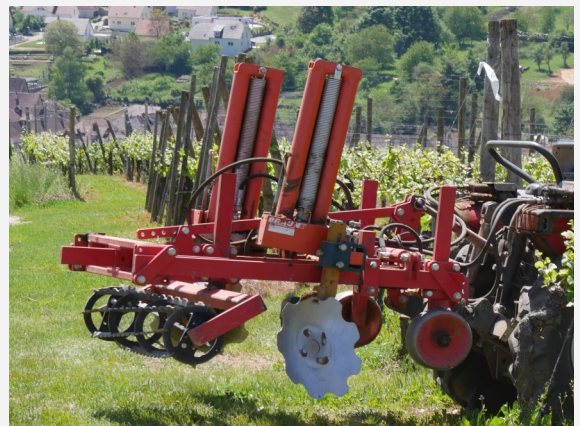
Mit Zinnen versehenen Scheiben sind ausgezeichnete Werkzeuge für den ersten Durchgang.
