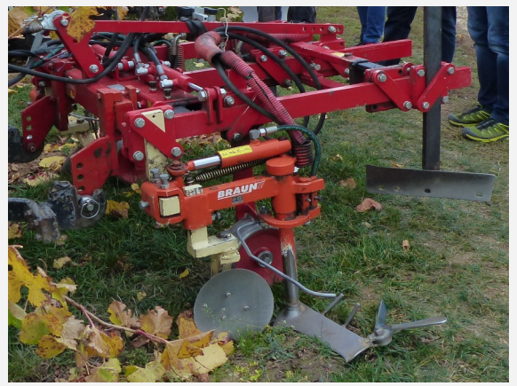
Hackmesser sind ausgezeichnete Pflegewerkzeuge zum Mähen unter der Reihe.
