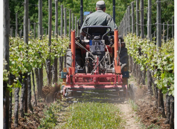
Die Kombination der Scheibe zum Häufeln der Erde und des Hackmessers ist zum Entkrauten unter der Rebstocklinie wirksam.
