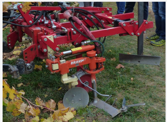
Die Arbeitsqualität des Messers hängt von der Arbeitsgeschwindigkeit und dem Abstand zwischen dem Taster und dem Messer ab.
