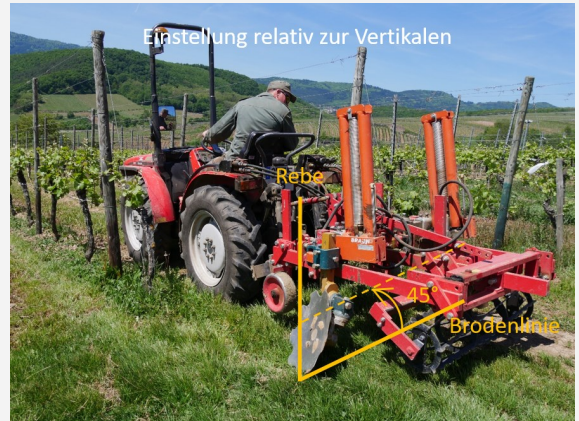
Der Neigungswinkel der Scheibe beträgt 45^\circ zum Boden.
