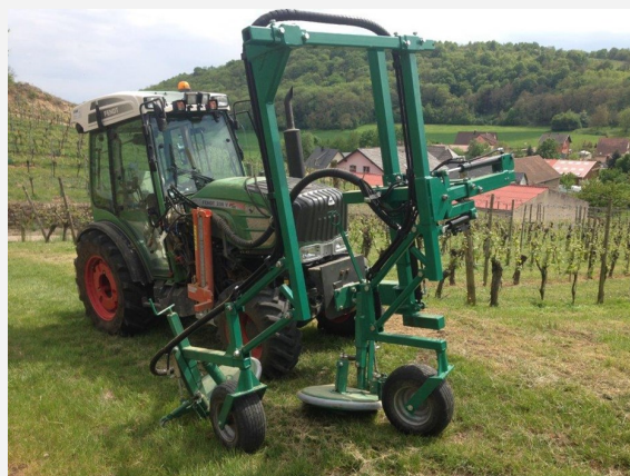
Von einer Gruppe Winzern benutzte Zwischenreihe-Mähmaschine.
