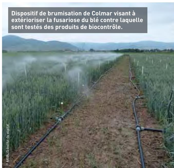
Dispositif de brumisation de Colmar visant à extérioriser la fusariose du blé contre laquelle sont testés des produits de biocontrôle.
