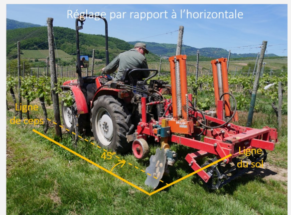
L'angle d'inclinaison du disque est de 45° par rapport à la ligne de ceps.
