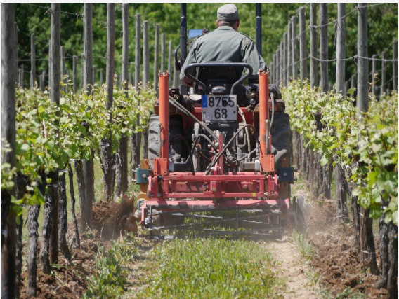
L'association du disque chasseur et de la lame bineuse est efficace pour désherber sous le rang de vigne.
