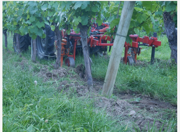
L'efficacité des lames intercepts diminue lorsque les adventices sont trop développées.
