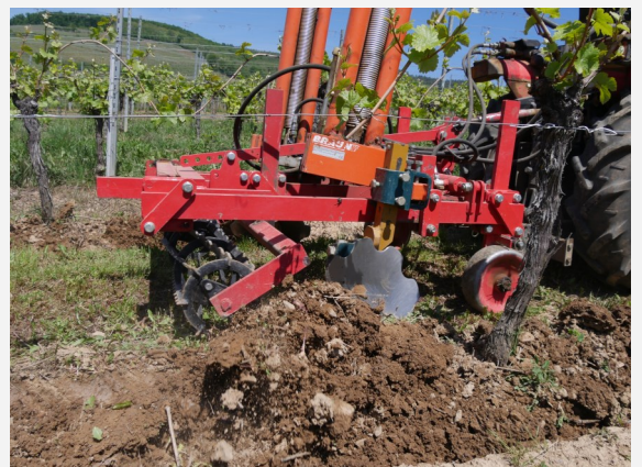
Mal réglé, les disques chausseurs peuvent projeter de la terre sur l'inter-rang.
