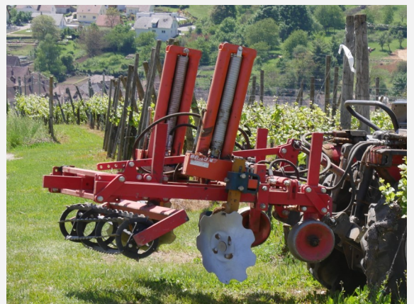
Les disques crénelés sont excellents outils pour effectuer le premier passage.
