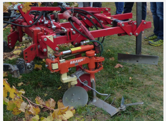
La qualité de travail de la lame dépend de la vitesse de travail et de la distance entre le palpeur et la lame.
