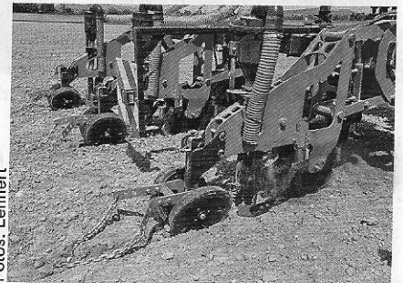
Die Rollen drücken den Schlitz zu und die Kettenglieder ebnen die Reihen ein.
