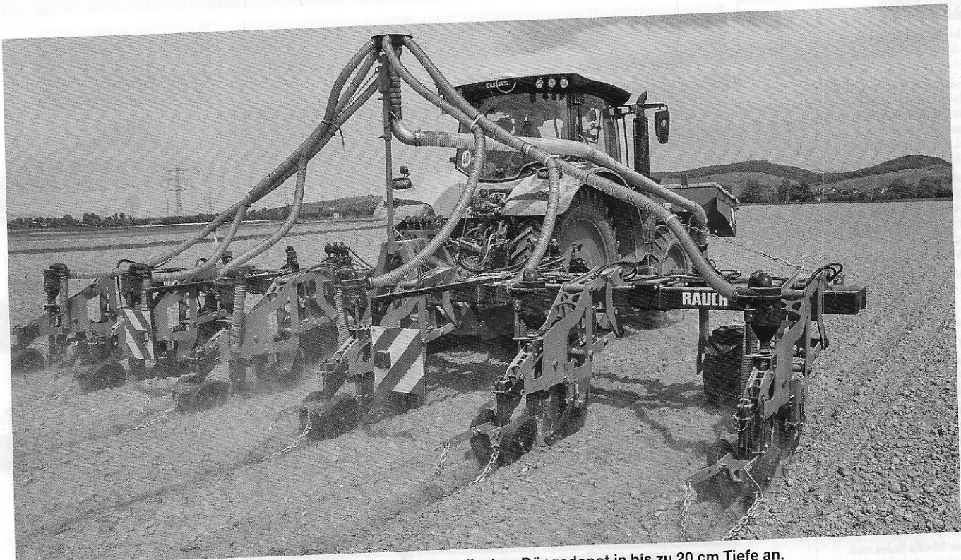
Der Prototyp legt zwischen jeder zweiten Maisreihe ein mineralisches Düngedepot in bis zu 20 cm Tiefe an.
