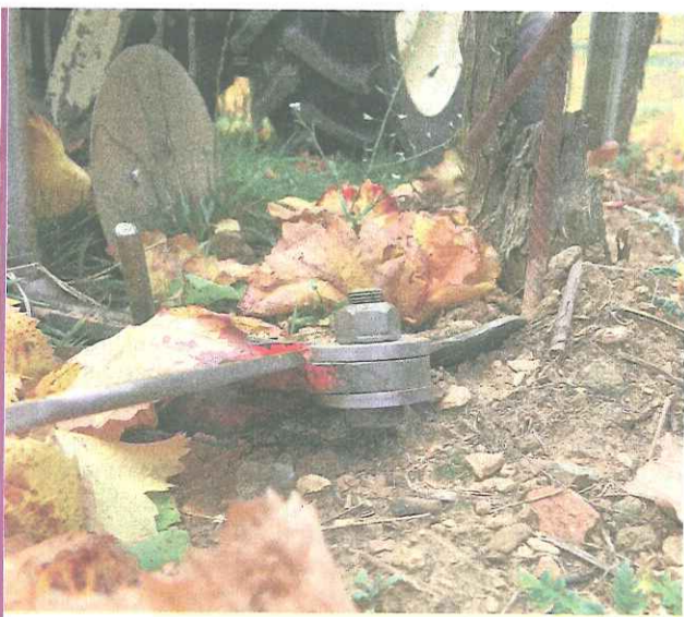
Le désherbage mécanique sous le rang de vigne est une méthode permettant de se passer d'herbicides chimiques.
