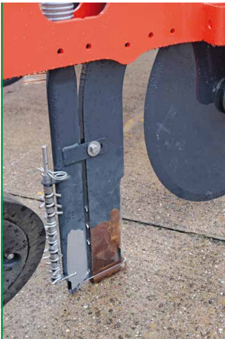
Le couteur est associé à une tige métallique équipée de ressort qui doivent permettre de ramener rapidement de la terre dans le sillon créé par le disque ouvreuse.
