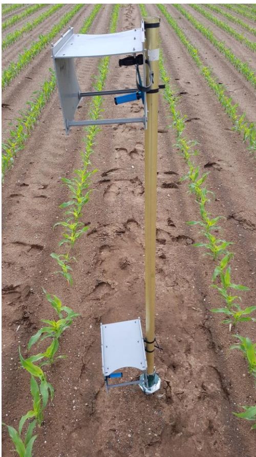
Dispositif de mesure mis en place par ATMO Grand Est (tubes passifs NH 3 )
