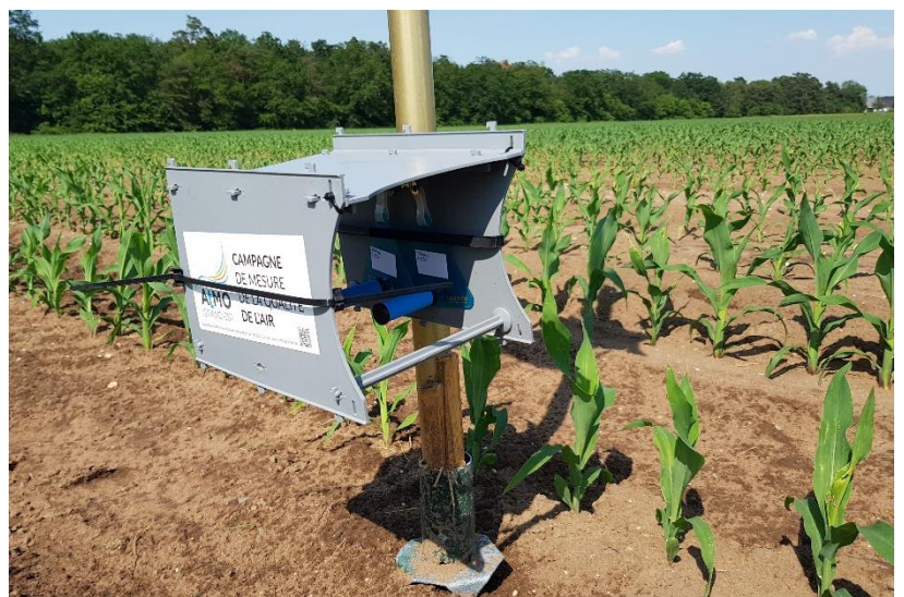
Dispositif de mesure mis en place par ATMO Grand Est (tubes passifs NH 3 )
