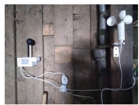
Fig. 2 ► Les capteurs Pessl et MoBiMets mesurent en temps réel l'humidité et la température.
