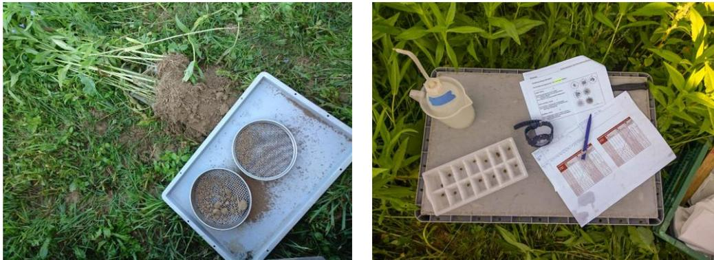
**Abbildung 4: Gewinnen von Bodenaggregaten zwischen 3-5 mm durch Siebung (links) und Ermittlung der Aggregatstabilität mittels Zerfallstest in Eiswürfelbehältern (rechts).**
