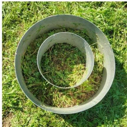
**Abbildung 5: Beispiel eines Doppelringinfiltrometers nach Abschluss der Messung.**
