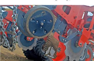
Das Injektionsmodul in ausgehobenem Zustand von der Seite betrachtet. Von rechts: Scheibensech zum Aufschlitzen des Bodens; Injektionssech, ganz unten mit "Maulwurf", zur Erzeugung eines "Maulwurfsganges", in dem der Dünger platziert wird; auf halber Höhe hinter dem Düngerdurchflussrohr die Kratzfeder zum Schließen des Schlitzes; danach Andruckrollen und eine Kette zum Einebnen.
