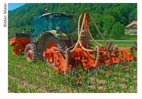
Drucktanks mit luftdichtem Deckel im Frontanbau, mit einer Geschwindigkeit von zehn bis Stundenkilometern vierzehn fahren. Ansonsten sind die Ingegenüber jektionseinheiten dem ersten Prototyp unverändert, da sie eine präzise Platzierung des Düngers im Boden garantieren. Die Sechs-Meter-Bauart hat sich dieses Jahr nach ungefähr 500 Hektar gedüngter Maisfläche im Elsass sehr bewährt und hat laut Herstellerangaben durchaus das Potenzial, in Serie gehen zu können.
