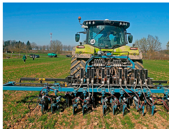
Das Innov.AR-Versuchsgerät LiqInject 2020 platziert den flüssigen Stickstoffdünger etwa doppelt so tief wie das Injektionsstachelrad, das heißt zehn Zentimeter.
