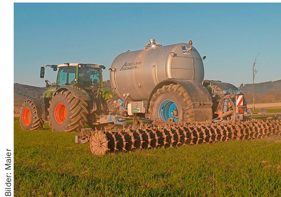
Mit dem Injektionsstachelrad wird der Flüssigdünger circa fünf Zentimeter tief platziert.
