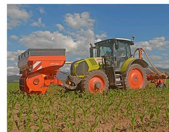
Prototyp von Rauch für Festdünger mit sechs Metern Arbeitsbreite und vier Injektionsreihen für acht Maisreihen und bis 15 km/h Arbeitsgeschwindigkeit dank eines Drucktanks.
